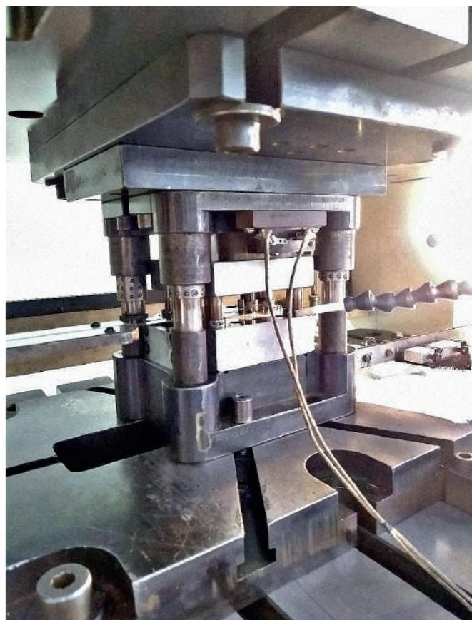
Рис. 3. Штмп для изготовления выводных рамок производства АО «ЗПП»
