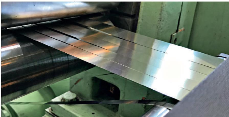
Рис. 4. Продольная резка металлической ленты на штрипсы
