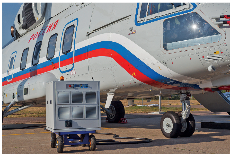
Рис. 2. Аэродромный источник электропитания переменного тока с выходной мощностью 32 кВА для аэродромного обслуживания вертолета МИ-38
