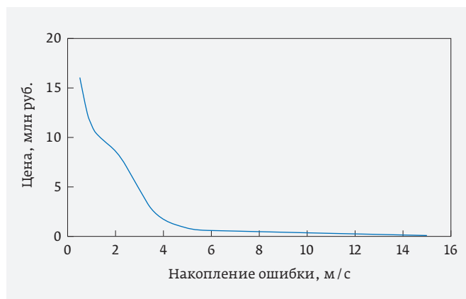
Рис. 1. Стоимость БИНС с разной скоростью накопления ошибки (погрешностью определения координат на плоскости)
