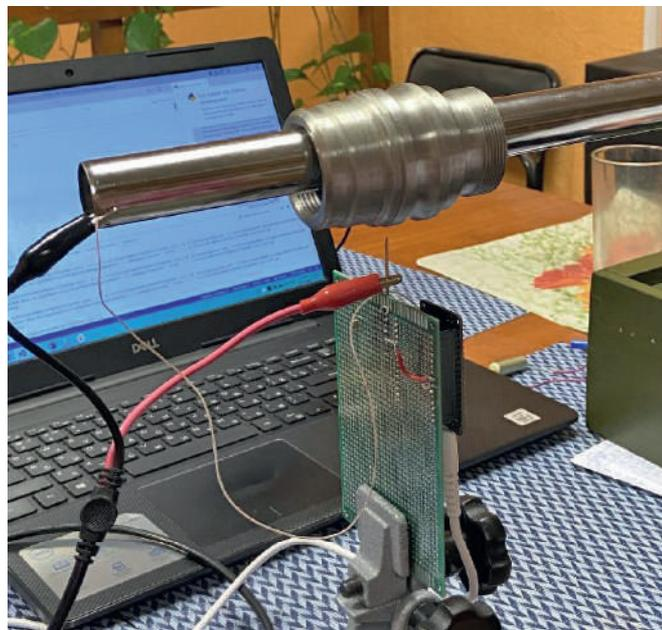
Рис. 9. Расположение датчика под деталью
