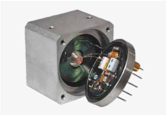
Рис. 3. Магнитная система перестройки частоты ГР, состоящая из основной и подстроечной катушек
